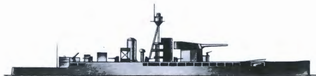
Монитор „Эребес“ (Англ.) Финский залив 1916 г. 8 000 т 6 000 л.с. 12 узл. 226 чел. Дл. 123 2-381 — Б-102 Ш. 27 8-102 — Р-152 Ос. 3,4 2-75 — Бш-330 2-76 зен. П-102
