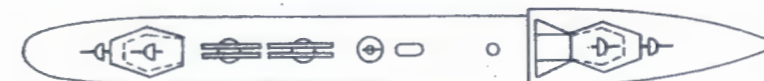
Эскадренный миноносец „Виктория“ (Англ.) Финский залив 1917 г. 1 480 т 27 000 л.с. 31 узл. 110 чел. Дл. 100 4-102 4 надв. — Ш. 9 1-76 зен. — Ос. 3,3 —
